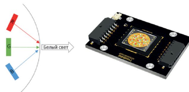
Рис. 5. Принцип действия и пример внешнего вида полихромного СД 4
