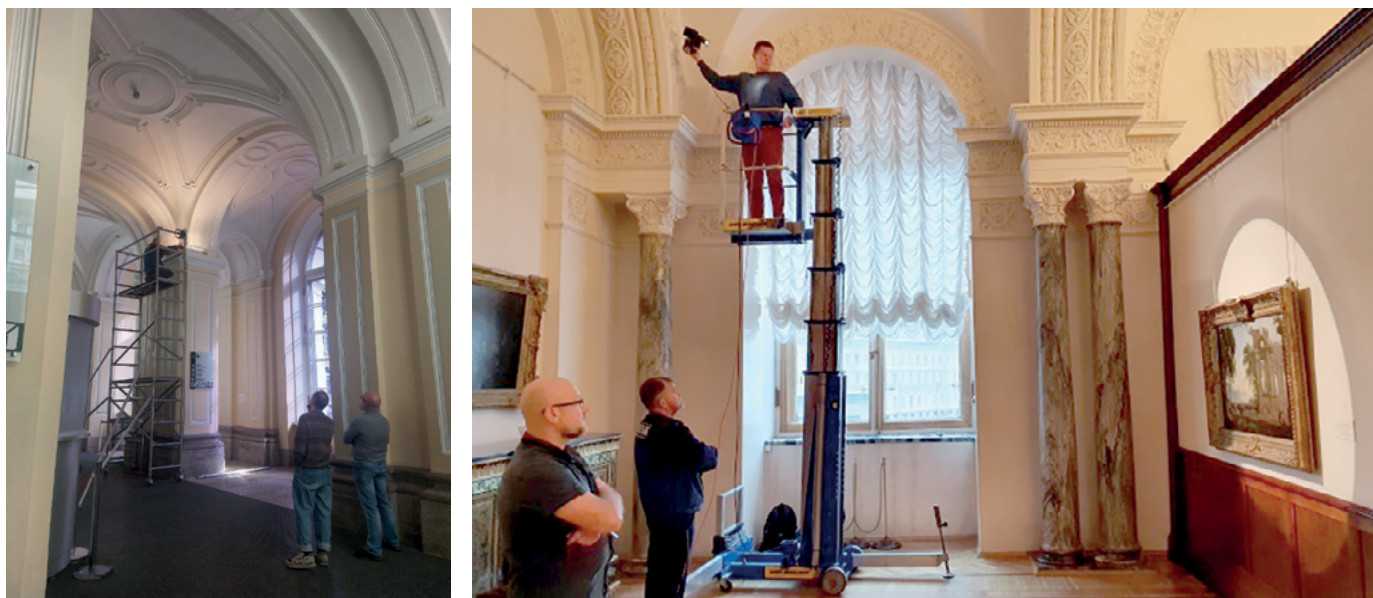
Рис. 49. Проведение натурного моделирования освещения: сводов потолка (слева) и живописи (справа)
