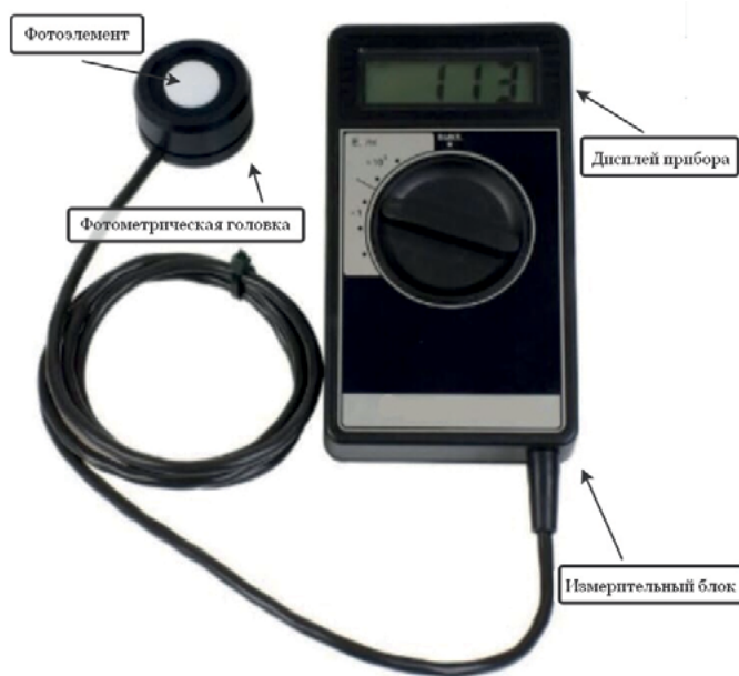
Рис. 43. Прибор для измерения характеристик освещения и его основные составляющие
