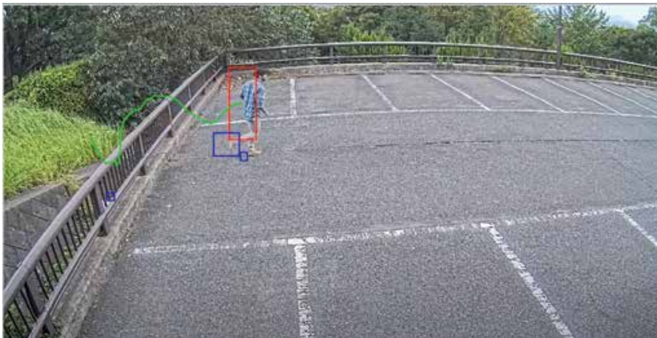
Рис. 31в. Виды видеоаналитики: пересечение линии
