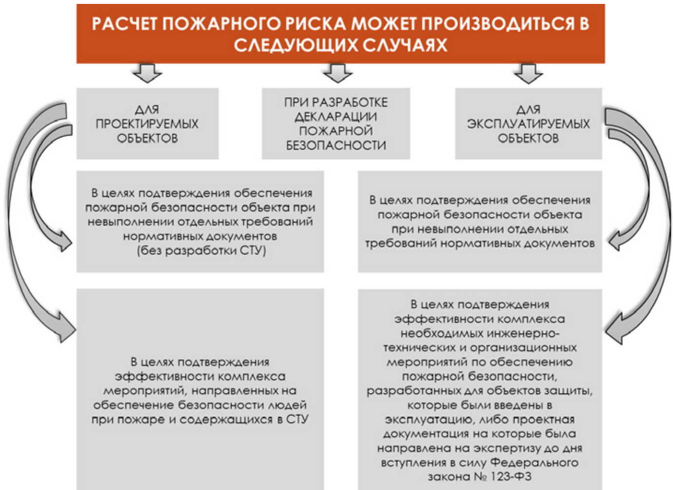
Рис. 5. Случаи проведения расчета пожарного риска.
