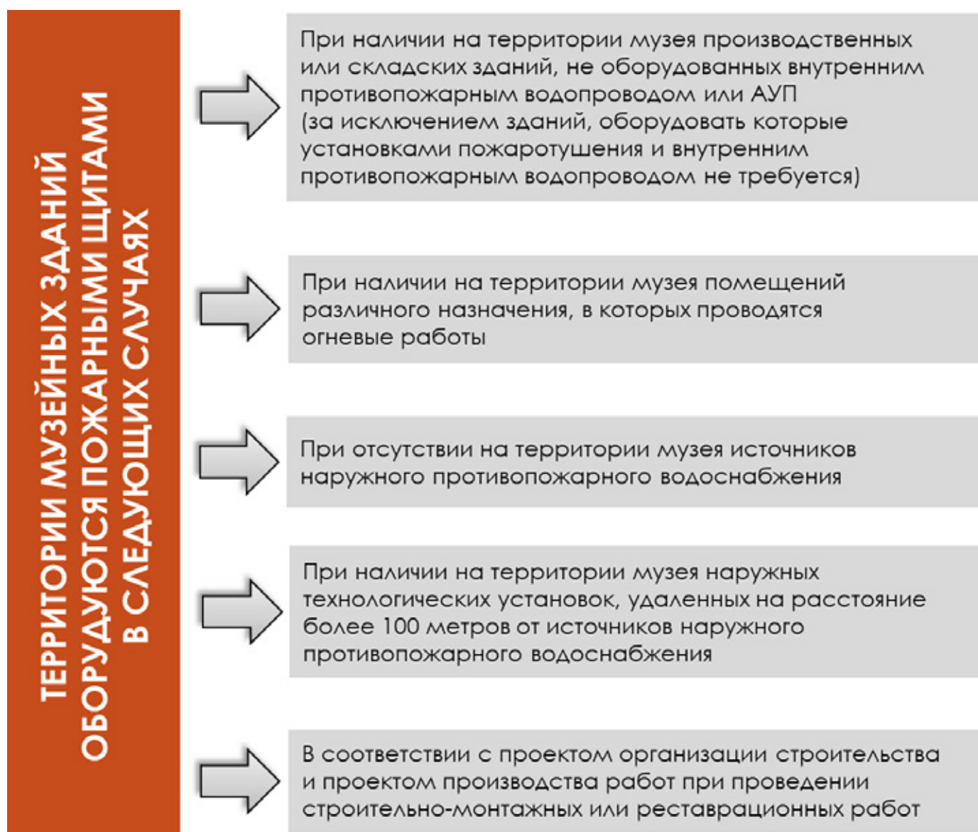
Рис. 8. Необходимость оборудования пожарными щитами территорий объектов.
